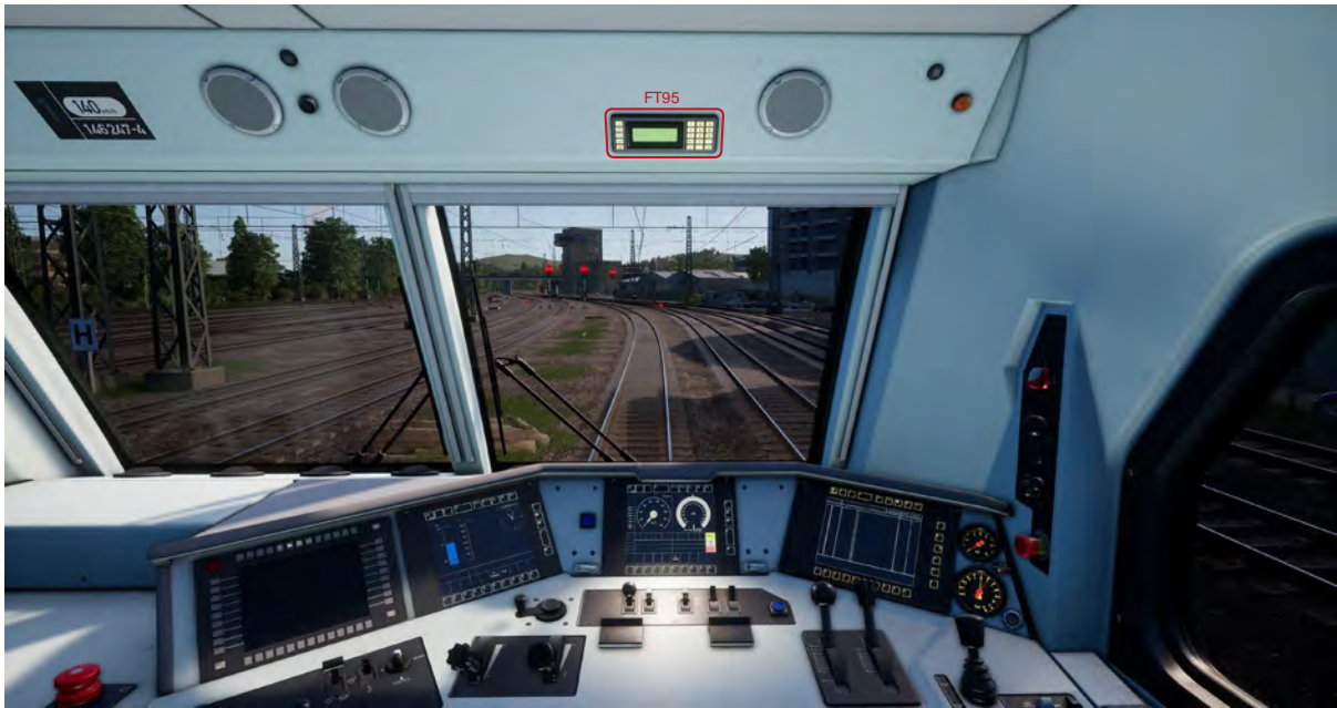
▲ Emplacement de l'unité FT95 dans la DB BR 146.2 et dans la voiture-pilote DB BR 766.2 DBpbzfa ▼
